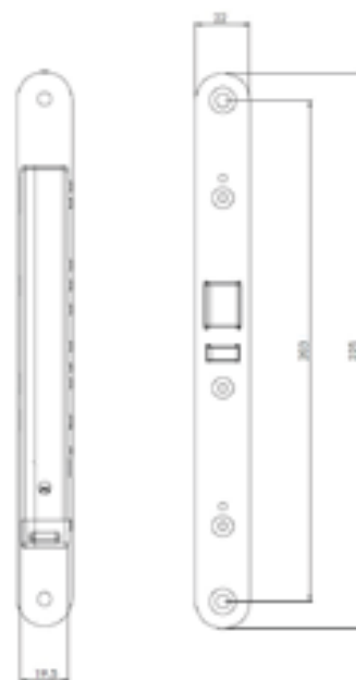
Målsatt tegning for STEP 120. Målsatt tegning for STEP 110 finner du på steplock.no
