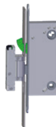
Hakereile som er låst ut i el-sluttstykkets faste uttak og således blokkerer dørens adgangs kontrollsystem/ kodelås eller dørautomatikk.
