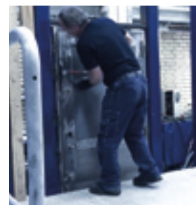
Bildet viser STEP 18 Secure montert med Stålprofil i en test hos RISE.
